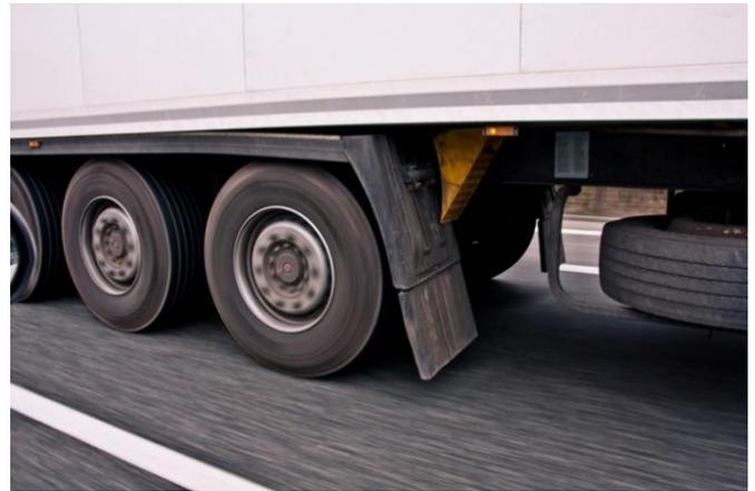
Cela est principalement dû à la résistance au roulement, l'une des principales forces qu'un véhicule doit surmonter pour continuer à se déplacer. Les fabricants de pneus de véhicules offrent des pneus à faible résistance au roulement, ce qui entraîne une consommation de carburant plus faible et une durée de vie plus longue. Selon les tests menés par Michelin<sup>2</sup>, les pneus à faible résistance au roulement peuvent économiser jusqu'à 80 litres de carburant au cours de leur durée de vie.
